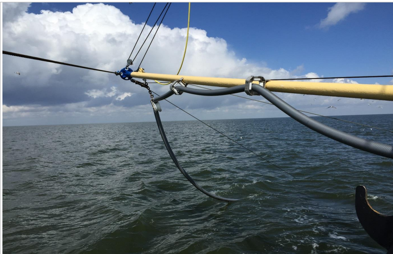
Figuur 8 De slang waardoor de vangst gereguleerd aan boord wordt gepomp
