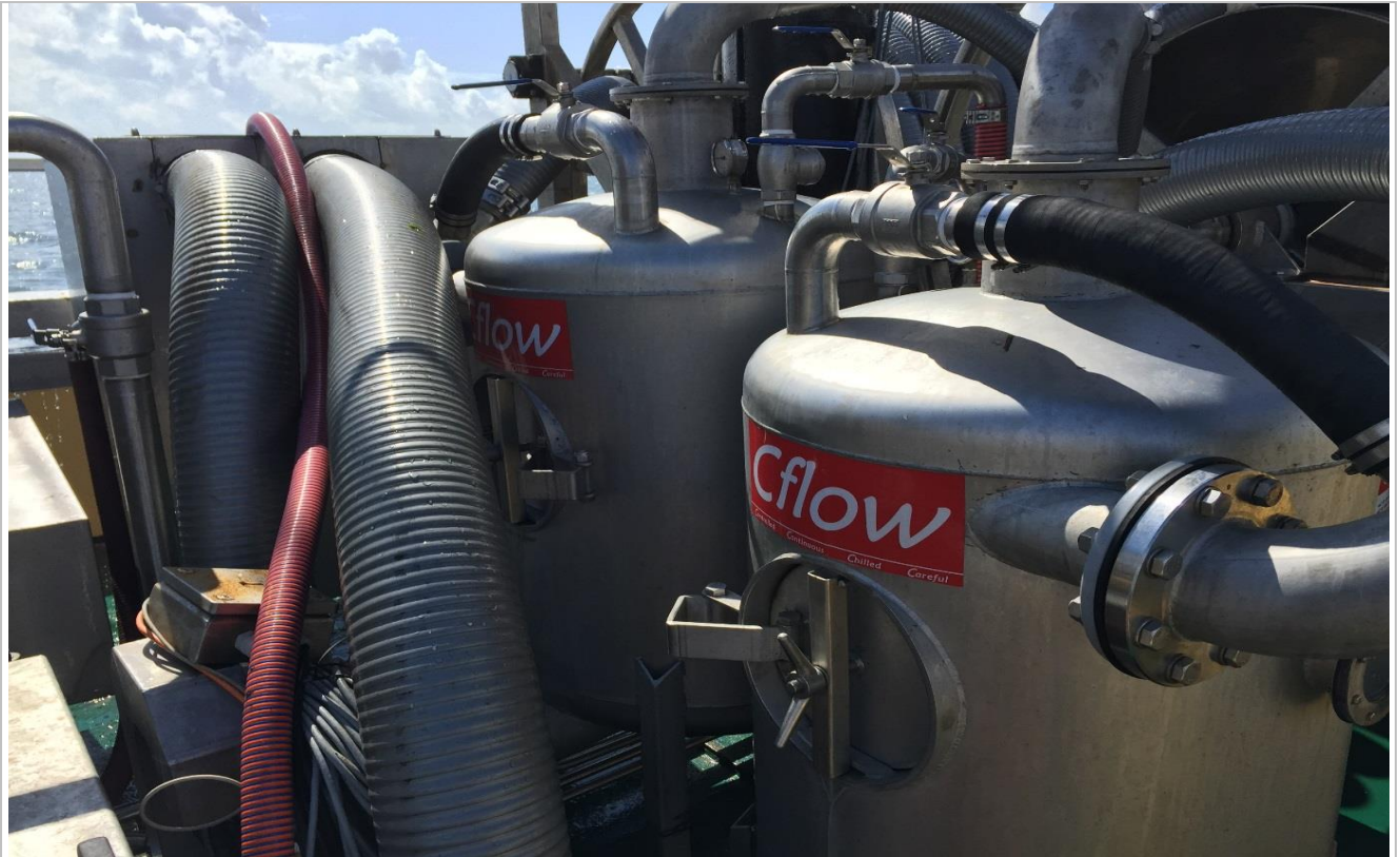
Figuur 7 Vacuümpomp van leverancier Cflow aan boord GRE 5
