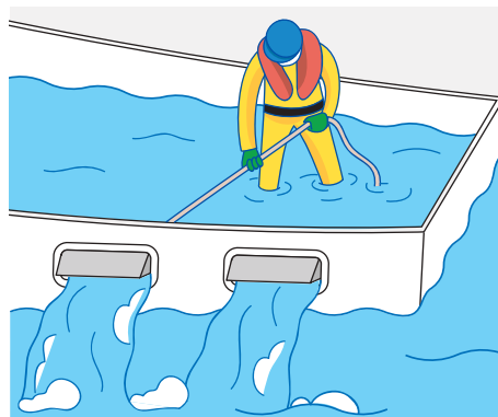
VI-7 Water stroomt op het dek, wat leidt tot het effect van de vrije oppervlakken (volgens Transport Canada, 3/2003 aangepast)
