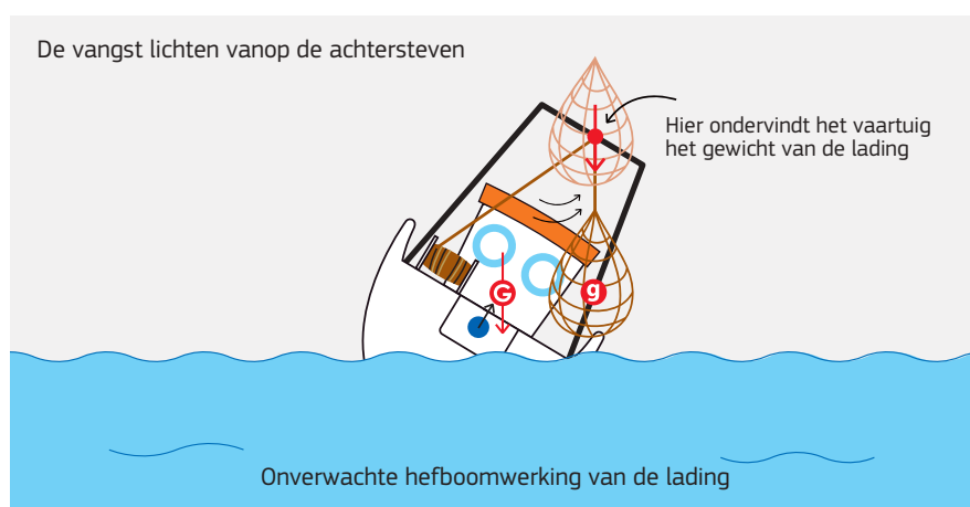
VI-12. Hijsen vanaf een brug op de achtersteven
