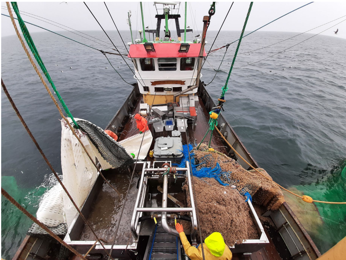
Figuur 18. Beeld van de praktijkproef met de zogenaamde Kiwi-kuil (links, stuurboord) en een traditioneel tuig (Rechts, bakboord). In deze proef is gevist met 4.5m brede boomkorren met een kettingmat in het gebied west van Scheveningen . De trekduur van deze vangst betrof 120minuten. De mate waarin de strotbakken gevuld zijn met mosdiertjes laat duidelijk een beeld zien van een effectieve technische aanpassing.
