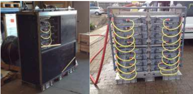
Figuur 5. Foto's van de overlevingsbakken. Links met de beschermende buitenwand, rechts de "naakte" rekken.
